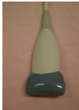
Imagem 2 – Sonda linear de alta frequência (5 - 12 MHz) com capacidades de Color Doppler e Doppler Espectral .
